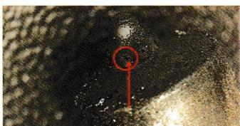
噴射された燃料が空気と最適に混合できずに未燃焼ガスが汚染物質を生成し、燃焼残留物となって堆積し目詰まりして故障します。
